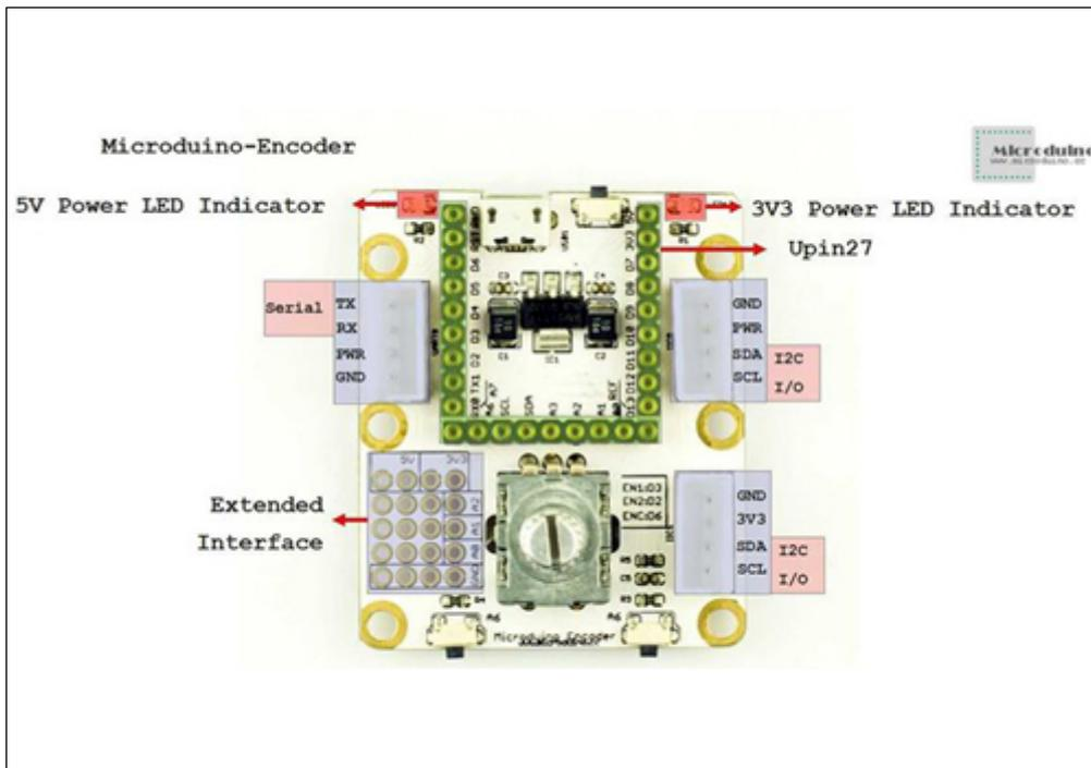
Shield per Microduino che facilita il collegamento con altri moduli e sensori. Dispone di pulsante di reset, LED di stato, una piccola area con piazzole (3V - 5V - A0-A1-A2), connettore micro, pulsanti analogici connessi ad A6, due interfacce I<sup>2</sup>C, una interfaccia seriale, regolatore di tensione 3V e 5V (a ponte a saldare). Compatibile con l'IDE di Arduino. Dimensioni (mm): 49x41x6.
