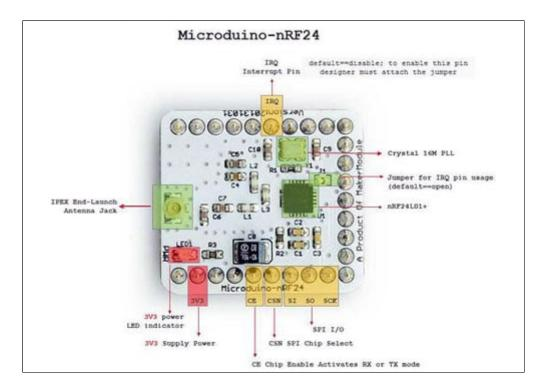
Basato sul chip nRF24L01+, un ricetrasmettitore a 2,4 GHz ISM (Industrial, Scientific and Medical), quest permette la trasmissione senza fili di dati ad alta velocità. Dispone di funzione di risposta automatica, ritra di trasmissione 0 dBm, distanza max. 100 metri senza ostacoli, dimensioni (mm): 28x25,4x7,5.
