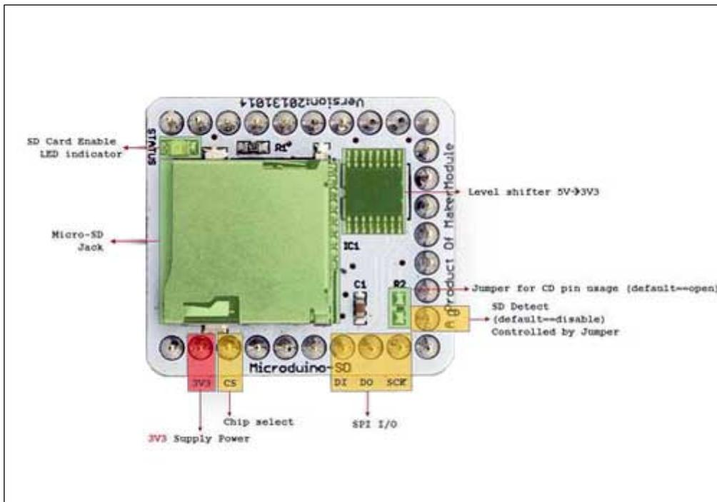
Questo shield per Microduino permette di leggere e scrivere dati su una scheda di memoria micro SD card. Dispone di connettore maschio/femmina per impilare i vari moduli, LED di stato. Dimensioni (mm): 30,5x20
