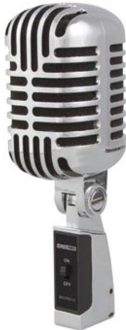
Microfono dinamico stile retrò su bobina mobile. Corpo in metallo pressofuso cromato. Diagramma polare: cardioide, risposta in frequenza: 50 Hz - 16 kHz, sensibilità: -49 dB  $\pm$  3dB, impedenza: 250 ohm  $\pm$  30%, uscita: XLR, interruttore on/off, dimensioni (mm): 245x165x70, peso: 500 grammi.
