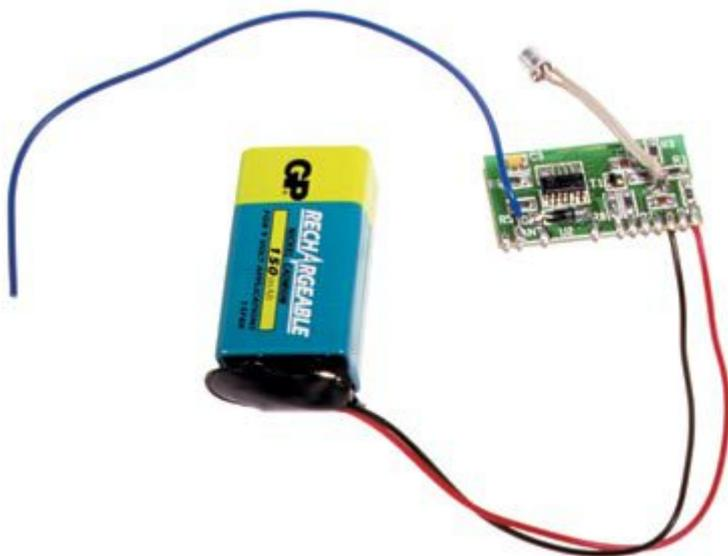
Grazie all'impiego di un circuito di attivazione vocale (vox), questo piccolissimo trasmettitore UHF assorbe a riposo una corrente inferiore a 2 mA. Lo stadio RF utilizza il modulo Aurel TX-FM Audio che garantisce una portata di circa 50÷300 metri. Il kit comprende tutti i componenti, la basetta forata e serigrafata e il modulo Aurel TX-FM Audio. Quale ricevitore può essere utilizzato il kit FT208K o il kit FT324K.
