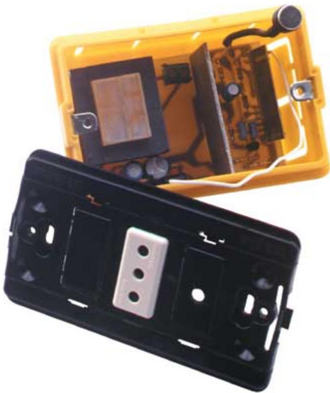
Trasmettitore microfonico UHF per intercettazioni ambientali da alloggiare nella scatola di qualsiasi presa a muro; un perfetto camuffamento del circuito ed un
