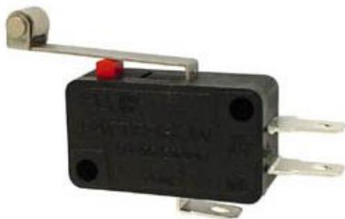
È dotato di una robusta levetta in metallo con rotella. Dispone di un contatto aperto (N.O) e di uno chiuso (NC). I terminali sono a saldare. Fissaggio mediante viti o collante. Terminali per faston 4,8 mm.
