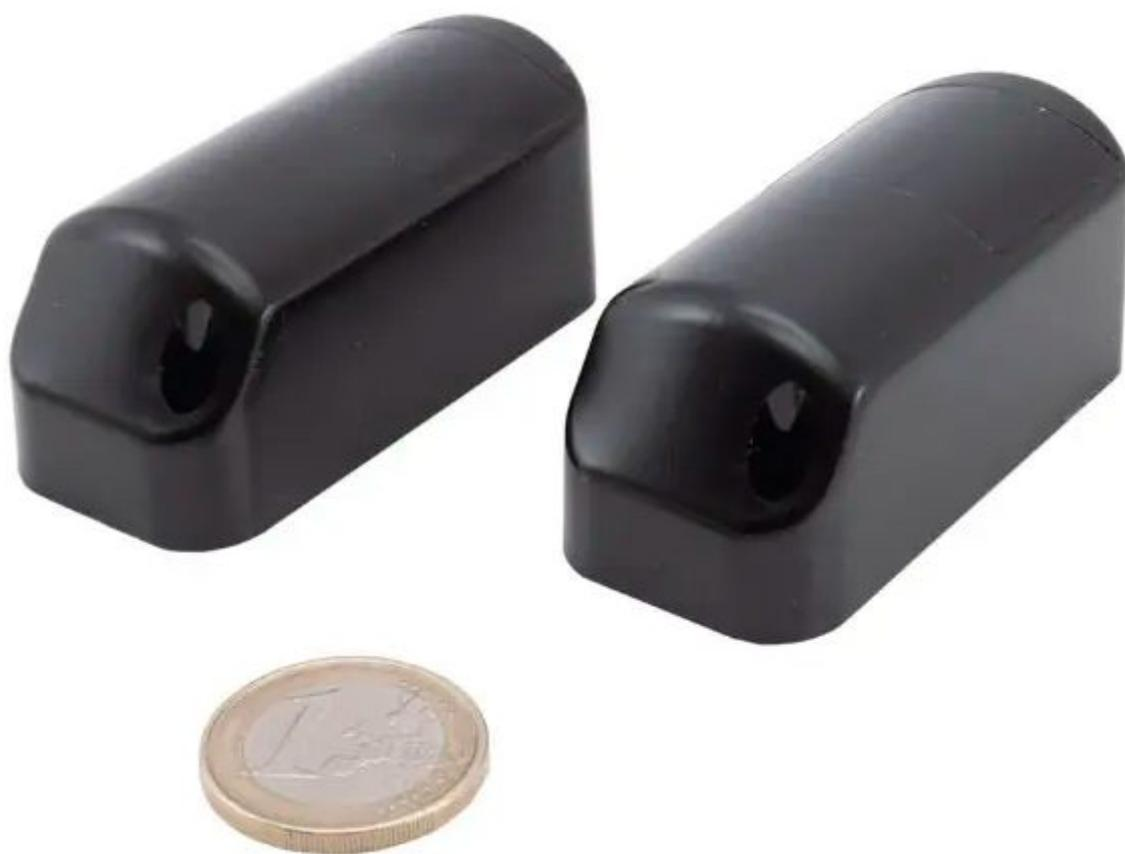
Mini barriera ad infrarossi sincronizzata, a singolo fascio e con portata di rilevamento di 15 metri in ambienti chiusi e 8 metri all'esterno. Dispone di un LED che indica l'allineamento dei fasci e genera il segnale di allarme solamente se il fascio viene interrotto. Il set è composto da un trasmettitore e da un ricevitore.
