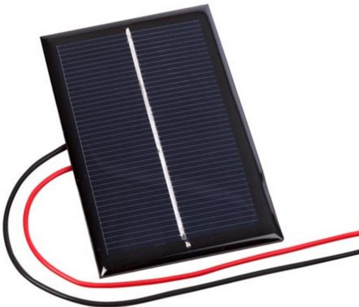
Cella fotovoltaica policristallina dalle dimensioni estremamente ridotte ideale per effettuare esperimenti con l'energia solare. Tensione di uscita: 0,5 V Corrente massima: 800 mA Dimensioni: 72 x 46 x 2mm. Peso: 13 gr Lunghezza filo: 20 cm
