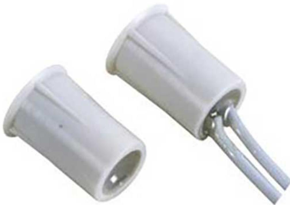
Contatto magnetico in miniatura da incasso. Ideale per essere impiegato in impianti d'antifurto, permette di controllare lo stato di porte e finestre. Quando i due elementi sono in prossimità il contatto è chiuso, allontanandoli si apre.
