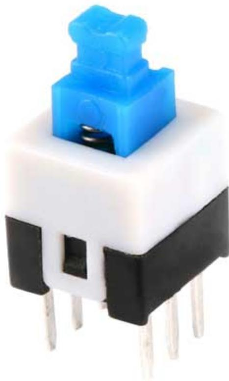
Mini deviatore a pulsante per montaggio diretto su PCB. Dimensioni (mm): 12,2x7x7, carico nominale: 0,3 A - 60 VAC / 1,5 A - 25 VAC, resistenza di isolamento:  $\geq 100$  Mohm, resistenza di contatto:  $\leq 0,02$  ohm, vita media parti elettriche e meccaniche: 100.000 cicli, temperatura d'esercizio: da -40°C a + 70°C.
