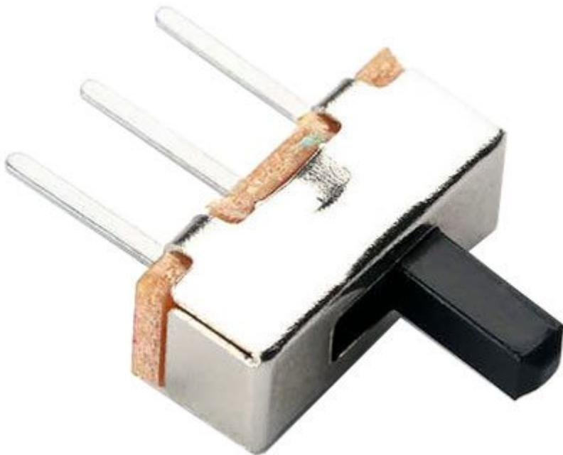
Mini deviatore a slitta per circuito stampato. levetta in grado di attivare carichi con assorbimento massimo di 100 mA a 12 VCC, 300 mA a 30 VCC. Dimensioni corpo (mm): 8,5x3,7x3,5.
