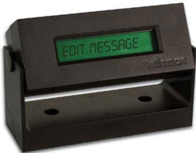
Generatore di messaggio con display LCD retroilluminato da una linea 16 caratteri. Massima lunghezza del messaggio 124 caratteri, velocità di scorrimento regolabile. Completo di interfaccia seriale RS232 per la programmazione mediante PC (programma disponibile sul sito [www.velleman.be](http://www.velleman.be)). Ideale per esposizioni, piccole pubblicità, taghette identificative, come display seriale in numerose apparecchiature, ecc.
