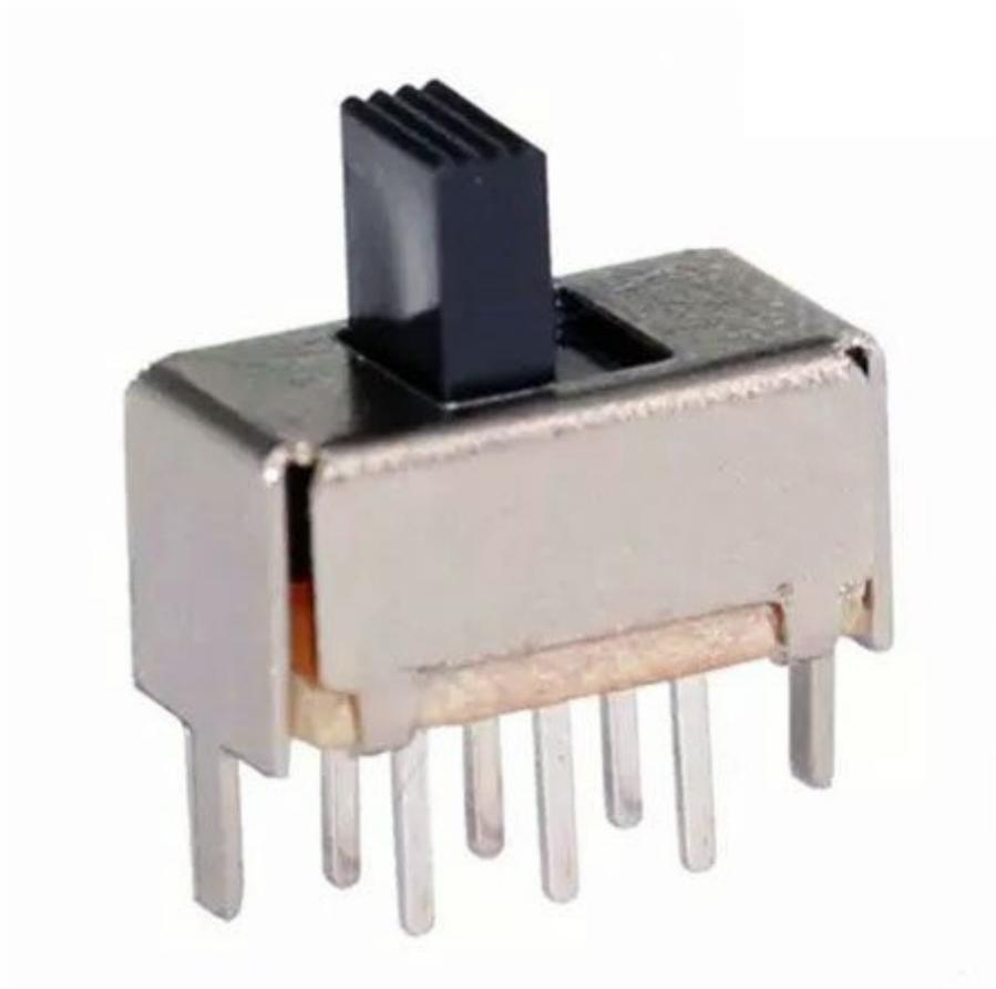
Mini doppio deviatore a slitta per circuito stampato. Levetta in grado di attivare carichi con assorbimento massimo di 300 mA a 50 VCC. Temperatura di funzionamento: da -25°C a +80°C, vita media: 10.000 cicli, dimensioni corpo (mm): 10,6x6,2x8,5.
