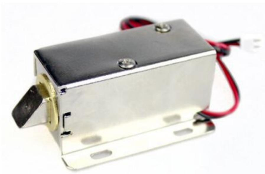
Mini elettroserratura con corpo in metallo e composta da un solenoide a trazione lineare con corsa di 10 mm. Alimentazione 12 Vdc, consumo: 1,5 A, tempo di sblocco: 1 secondo, dimensioni (mm): 54x39x28, peso: 150 grammi, temperatura di lavoro: da -40°C a +50°C. Può essere utilizzato ad esempio per la chiusura di cassette, piccoli armadietti, ecc.
