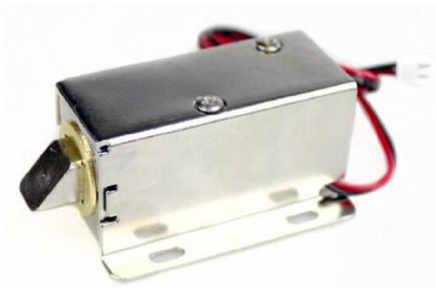
Mini elettroserratura con corpo in metallo e composta da un solenoide a trazione lineare con corsa di 10 mm. Alimentazione 24 Vdc, consumo: 1,5 A, tempo di sblocco: 1 secondo, dimensioni (mm): 54x39x28, peso: 150 grammi, temperatura di lavoro: da -40°C a +50°C. Può essere utilizzato ad esempio per la chiusura di cassette, piccoli armadietti, ecc.
