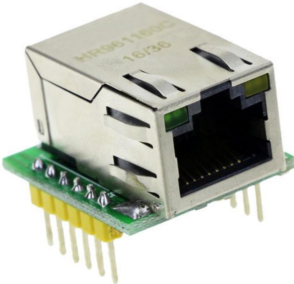
Modulo ultra compatto basato sul chip ethernet WIZnet W5500 con buffer di memoria interna 32 Kbyte, connettore ethernet RJ45. Supporta i protocolli TCP, UDP, IPv4, ICMP, ARP, IGMP e PPPoE. Il buffer di memoria interna da 32Kbyte è utilizzato per l'elaborazione del
