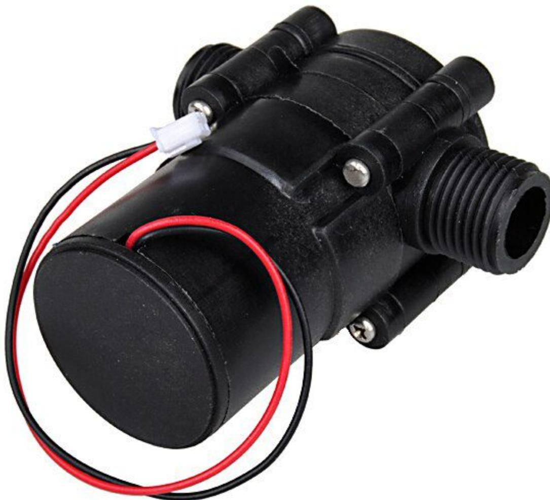
Mini generatore idroelettrico. Quando viene attraversato da un flusso d'acqua genera un tensione in uscita da 9,8 a 15 VDC e una corrente da 128 a 260 mA. E' possibile installarlo nella propria abitazione per ottenere energia pulita, per ricaricare batterie, alimentare piccoli dispositivi, ecc.
