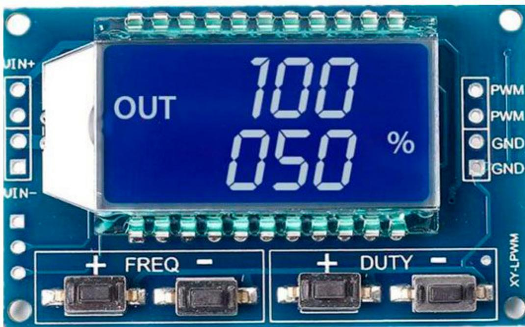
Dotato di display LCD retroilluminato, questo compatto modulo è in grado di generare un segnale PWM ad onda quadra da 1 Hz a 150 kHz con duty cycle regolabile da 0 al 100%. Tutti i parametri, impostati tramite 4 pulsanti o comunicazione seriale livello TTL, sono salvati automaticamente in una memoria non volatile. Particolarmente indicato come generatore di segnale ad onda quadra per controllare il driver di un motore, per microcontrollori, dimmer, ecc. Alimentazione: da 3,3 a 30 VDC.
