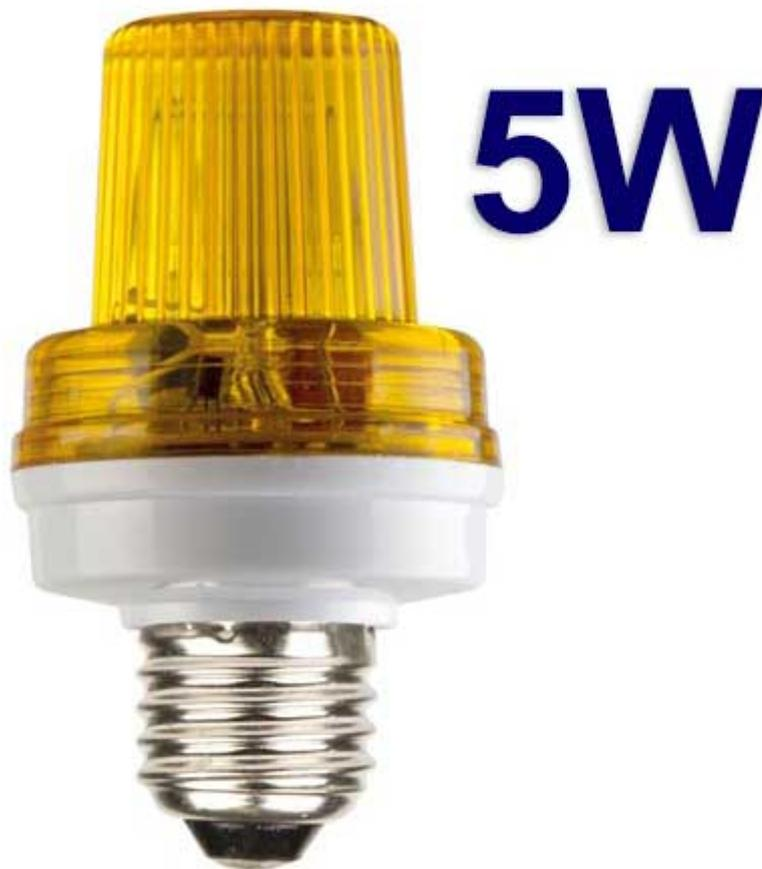
Mini lampada strobo gialla in grado di effettuare 40 lampeggi al minuto. Alimentazione: 230 Vac/5 watt, attacco E27, peso: 54 grammi, dimensioni: Ø50 x 95 mm.
