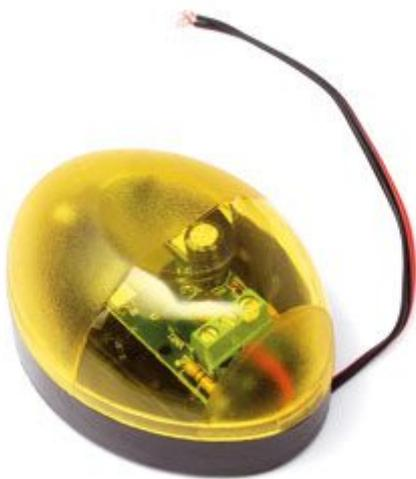
Lampeggiante con lampada composta da 3 LED da 1 watt ciascuno. Due modalità di funzionamento, luce fissa e lampeggiante (selezionabile tramite jumper), alimentazione 24 Vac-Vdc o 220 Vac. Ideale per sistemi di allarme, per segnalare pericoli, per attrarre l'attenzione, ecc. Dimensioni: 80 x 60 x 39 mm.
