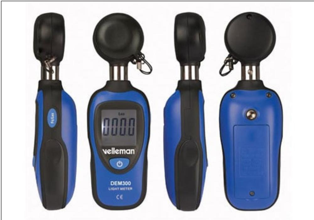
Strumento per la misura dell'illuminazione con indicazione digitale da 0 lux a 200.000 lux. Dispone di sensore che impiega un fotodiodo al silicio con filtro, display LCD a 4 digit con retroilluminazione, unità di misura selezionabili LUX / FC, indicazione di min e max, indicazione di batteria scarica, indicazione fuori scala. Alimentazione: batteria 9V (inclusa).
