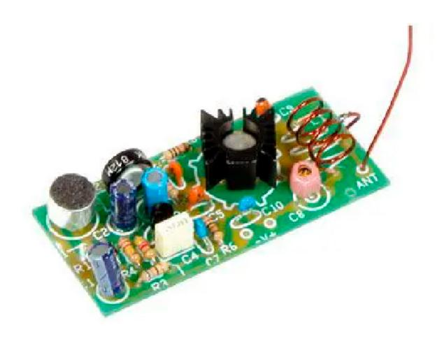
Trasmettitore miniatura operante in banda FM, cioè tra 88 e 108 MHz, ideale per realizzare microspie o per costruire una piccola emittente radiofonica per il proprio circondario. Si ascolta tranquillamente con un ricevitore radio FM. E' il progetto più semplice per avvicinarsi al mondo della radiofrequenza. La realizzazione e la messa a punto non richiedono l'impiego di strumenti di misura né di particolari attrezzature.
