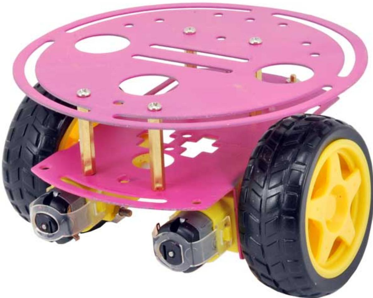
Piattaforma robotica universale costituita da un corpo in metallo (verniciato), due motoriduttori, due ruote con diametro di circa 66 mm e un ballcaster in metallo con ruotino in nylon. Utilizzata con Arduino, Fishino o altro permette di realizzare in modo semplice e veloce dei robot completi. Viene fornita completamente montata.
