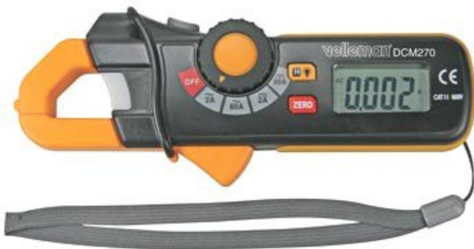
Mini pinza amperometrica per misurazioni AC/DC con display LCD retro-illuminato da 3 2/3 cifre a 2400 conteggi. Protezione contro i sovraccarichi, individuazione di tensione senza contatto (100-600 Vac), misurazione frequenza, autospegnimento e indicatore di batteria scarica. Alimentazione con 2 batterie tipo AAA 1,5V. Viene fornito con custodia in plastica.
