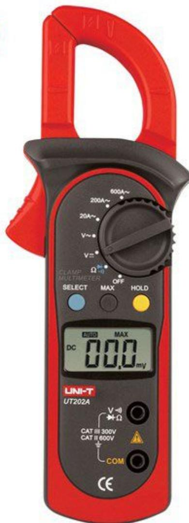
Pinza amperometrica con multimetro digitale con display LCD retro-illuminato da 3 cifre  $\frac{1}{2}$ . Misura tensioni AC (max. 600 V), tensioni DC (max. 600 V), resistenze (max. 20 Mohm) e correnti AC (max. 600 A). Dotata di funzione data hold, buzzer di continuità, test diodi, indicazione batteria scarica, cambio portate manuale e spegnimento automatico. Alimentazione con 1 batteria da 9 V. Viene fornito con una pratica custodia per il trasporto, puntali, batterie e istruzioni in italiano.
