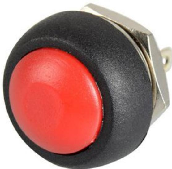
Mini pulsante da pannello. Colore: rosso, tipo di contatto: normalmente aperto, max. corrente: 1 A - 12 V, resistenza di contatto: <50 Mohm, resistenza di isolamento: >100 Mohm, temperatura di lavoro: da -25°C a +85°C. Dimensioni massime (mm): 21,6x17,6, diametro foro di fissaggio: 12 mm, terminali a saldare, peso: 3,5 grammi.
