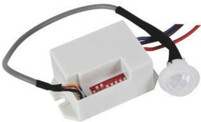
Composto da un mini sensore PIR e una centralina di controllo, permette di attivare al passaggio di una persona, un carico per un periodo di tempo regolabile tra 5 secondi e 8 minuti. Massimo carico controllabile: 800 W resistivo, 150 W fluorescente. Alimentazione: da 180 a 240 Vac.
