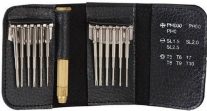
Pratico astuccio contenente un cacciavite portainseri con i seguenti inserti in cromo-vanadio: 3 con impronta a croce PH000/PH00/PH0, 3 con impronta a taglio: 1,5 / 2 / 2,5 mm e 6 con impronta a stella: T5 / T6 / T7 / T8 / T9 / T10. Lunghezza manico: 85 mm, lunghezza inserti: 55 mm. Dimensioni astuccio aperto: 192 X 95 X 20 mm, chiuso: 60 x 95 x 25 mm.
