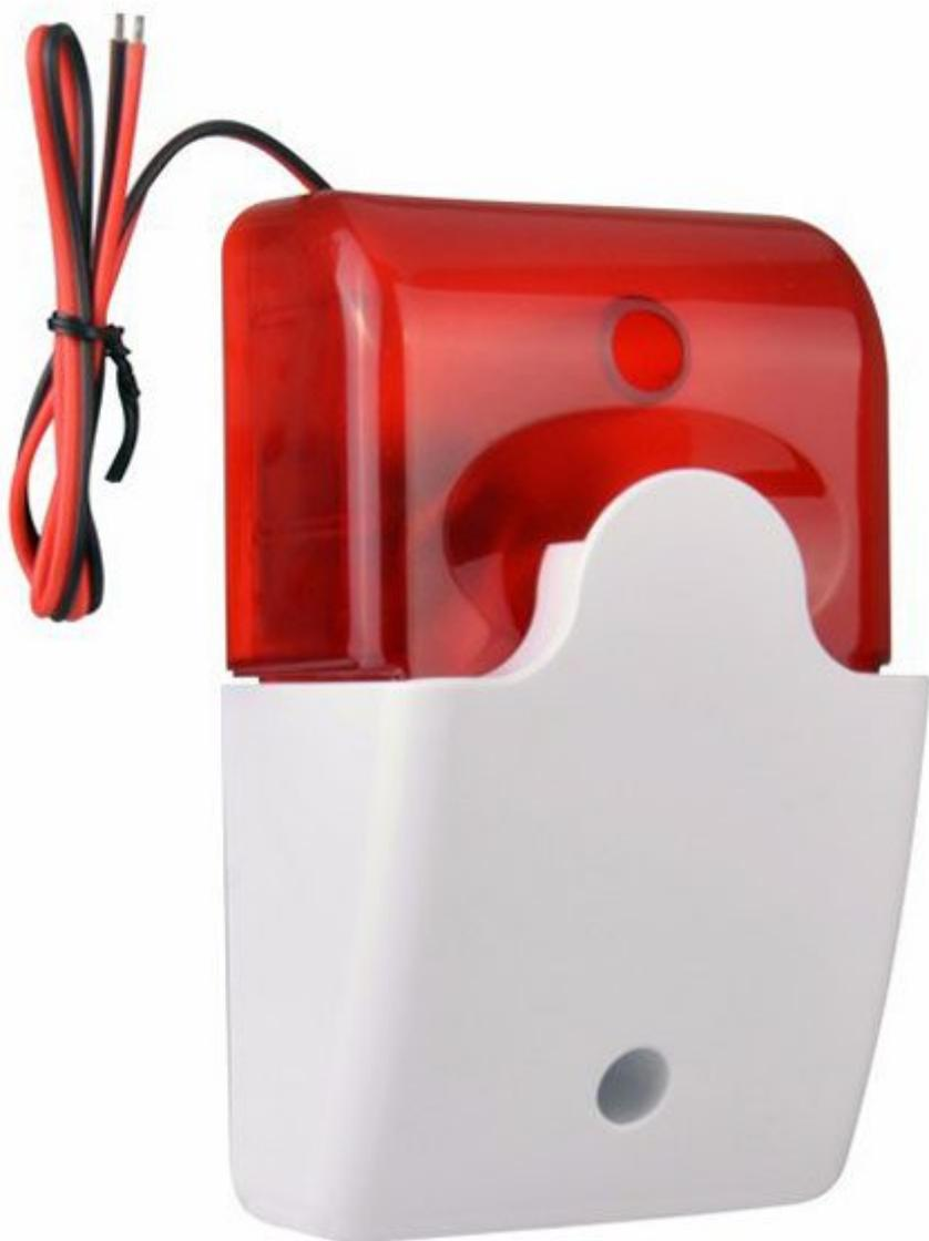
Mini sirena d'allarme da interno con lampeggiante rosso costituito da 4 LED, buzzer con 110dB di potenza. Custodia realizzata in ABS, alimentazione 12 VDC, consumo circa 300 mA, dimensioni (mm): 123x74x49, peso: 100 grammi. Si attiva non appena viene alimentata. Ideale per essere utilizzata in abitazioni private, uffici, ecc. Da abbinare a un sistema d'allarme pre-esistente.
