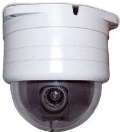
Mini Speed Dome da interno con sensore SONY CCD da 1/3" a colori. Dispone di ottica varifocal da 5 a 15 mm, una risoluzione di 540 linee TV, Pan e Tilt con 360° di rotazione orizzontale e 92° di inclinazione verticale, 128 preset (posizioni prestabilite) impostabili, controllo PTZ, protocollo di comunicazione: Pelco-D - RS-485. Alimentazione 12 Vdc / 1,2 A (adattatore di rete incluso).
