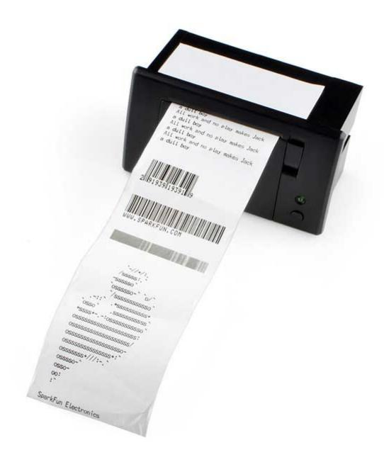
Piccola e compatta stampante termica con interfaccia TTL e alimentazione compresa tra 5 e 9 Vdc. Sul pannello posteriore sono presenti 2 connettori a 3 pin; uno per l'alimentazione e uno per la comunicazione seriale TTL. La velocità di trasmissione di default è di 19200 bps. È possibile interfacciarla con Arduino, Fishino e compatibili. La testina di stampa ha una durata nominale di 50 km.
