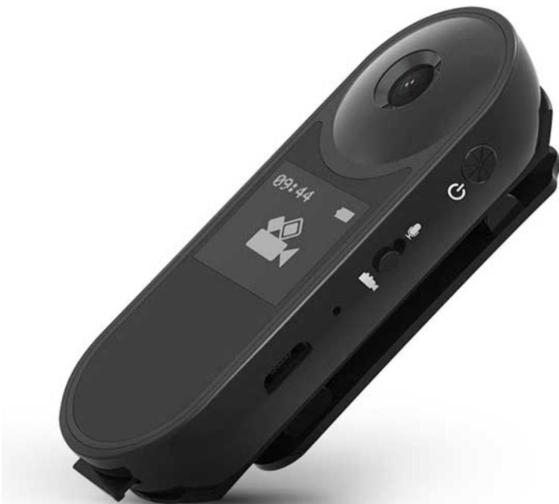
Mini telecamera con DVR dotata di display LCD. Estremamente leggera e compatta consente di registrare video e audio, scattare fotografie e memorizzare i file su SD card (acquistabile separatamente). La confezione comprende una clip per fissare la telecamera agli indumenti e un cavo USB per collegare il mini DVR al computer. Sul retro del dispositivo è presente un magnete che permette fissare il dispositivo ad un oggetto metallico. Batteria ricaricabile integrata.
