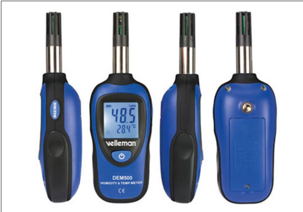
Mini termoigrometro digitale con display LCD retroilluminato a 3 digit 1/2. Permette di misurare il grado di umidità compreso in un range da 0% RH a 100% RH, la temperatura compresa in un range da da -20°C a +70°C (da -4°F a 158°F). Tempo di risposta 1 secondo, indicazione batteria scarica, visualizza simultaneamente umidità e temperatura (°C o °F), alimentazione a batteria 9 volt (compresa).
