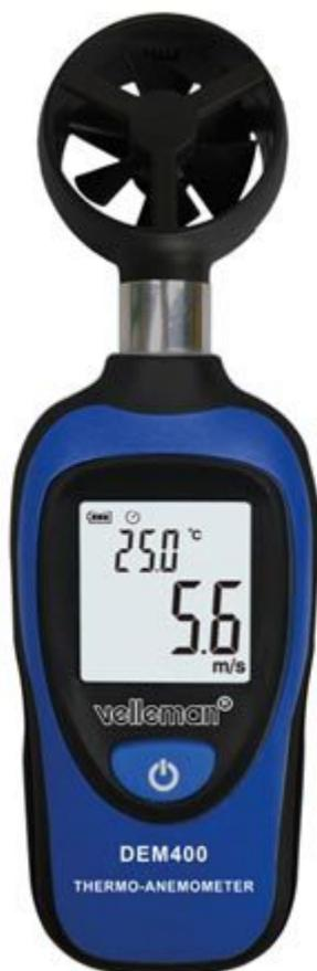
Strumento portatile che permette di misurare la velocità e la temperatura dell'aria. Ideale per eseguire rapidi controlli sulle bocchette di ventilazione. Lettura della temperatura in gradi Centigradi e gradi Fahrenheit, display LCD retroilluminato a 3 cifre, memorizzazione dei valori minimi e massimi rilevati, funzione di autospegnimento, indicatore di batteria scarica. Alimentazione 1 batteria da 9 V (inclusa).
