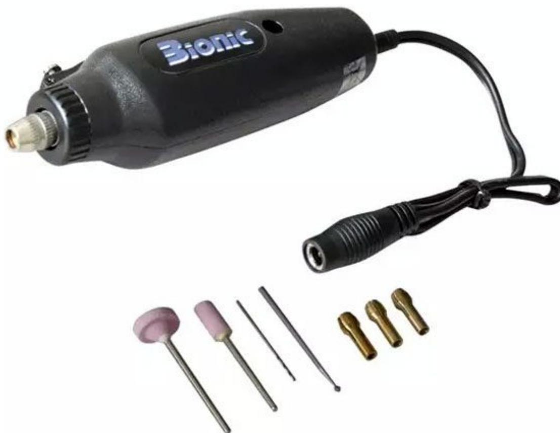
Mini trapano con velocità di rotazione di 12.000 rpm adatto per eseguire lavori di precisione. Diametro apertura mandrino: 0,8 mm - 3 mm. Alimentazione 12 VDC. Ghiera Collarino: diametro 22 mm. La confezione comprende: il mini trapano con interruttore on/off, 2 mole con alberino, 2 punte per incisione, 2 serraggi varie misure per mandrino.
