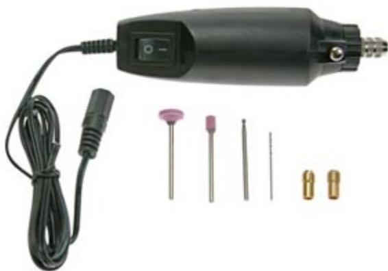
Mini trapano con velocità di rotazione di 12000 rpm adatto per eseguire lavori di precisione. Diametro apertura mandrino: 0,8 mm - 3 mm. Alimentazione 12 Vdc. Ghiera Collarino: diametro 22,70 mm. La confezione comprende: un mini trapano 12000 rpm con interruttore on/off, 2 mole con alberino, 2 punte per incisione, 2 serraggi varie misure per mandrino.
