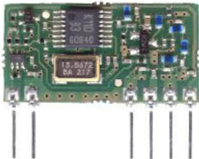
Il TXFM484/868MID è un modulo di trasmissione dati digitali funzionante contemporaneamente nelle bande 434 e 868 MHz, con modulazione FSK e antenna esterna per applicazioni Low Power Device.
