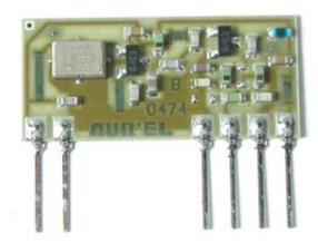
Modulo trasmettitore ad alte prestazioni AM OOK, quarzato mediante risuonatore SAW. Stadio "buffer" che garantisce sia la potenza che basse armoniche in uscita, consentendo elevata immunità ai disadattamenti. Ideale per sistemi a batteria a 3 Volt. In accordo con le Normative Europee.
