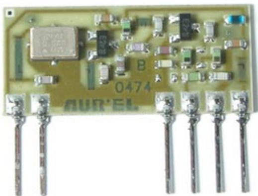
Modulo trasmettitore ad alte prestazioni AM OOK, quarzato mediante risuonatore SAW. Stadio "buffer" che garantisce sia la potenza che basse armoniche in uscita, consentendo elevata immunità ai disadattamenti. In accordo con le Normative Europee.
