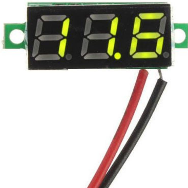
Voltmetro in miniatura (23x11 mm) con display a LED verde. È in grado di visualizzare tensioni continue da 2,5 a 30 volt utilizzando solo 2 fili, infatti utilizza la tensione da leggere per alimentare se stesso. Altezza digit: circa 8 mm, precisione: fino a 10 volt 0,01 volt – oltre i 10 volt 0,1 volt, temperatura di lavoro: da -10°C a +65°C. Filo rosso: positivo, filo nero: negativo.
