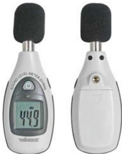
Mini [fonometro](#) con risoluzione di 0,1dB ed indicazione digitale della misura. E' in grado di rilevare intensità sonore comprese tra 40 e 130 dB. Dispone delle seguenti funzioni: minima/massima, cambio portata automatico, retroilluminazione on/off e spegnimento automatico. La confezione comprende: il fonometro e la batteria.
