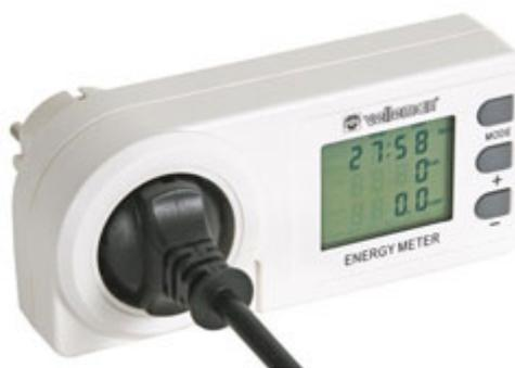
Per conoscere il consumo ed il costo dell'energia consumata da una qualsiasi apparecchiatura funzionante a tensione di rete. Alimentazione 230 Vac / 50 Hz; massimo carico applicabile 3,6 kW / 16 A; massimo tempo di registrazione 9999 h; massima indicazione del consumo 999,9 kW/h; doppia tariffa impostabile; batteria di back-up interna.
