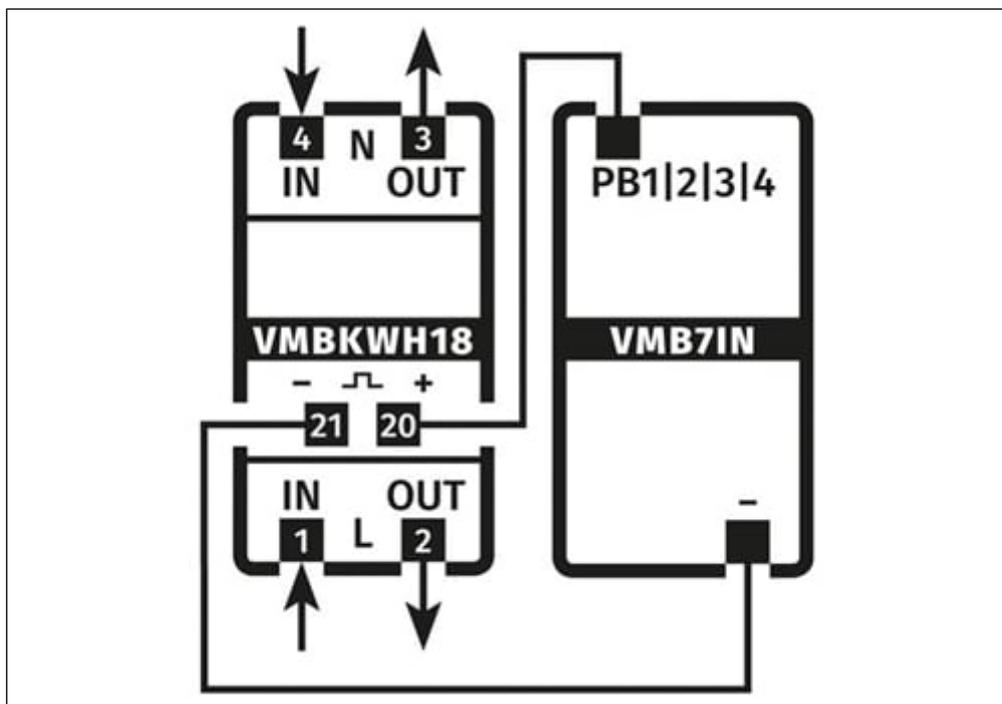
Modulo conta energia su guida DIN con display LCD (con retroilluminazione blu) per sistema monofase. Visualizza fino a 99999,9 kWh, dispone di LED indicatore che lampeggia ad ogni impulso, uscita impulsiva 1000 p/kWh e pulsante di reset. Contenitore per guide DIN standard (2 moduli). Può essere impiegato nel sistema Velbus oppure come semplice conta energia. Conforme Class 1, Class 2 e IEC62052-11, IEC62053-21.
