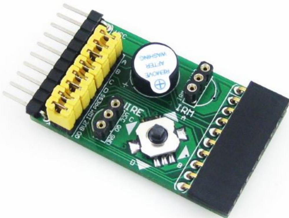
Scheda sperimentale da utilizzare nei test, corredata di connettore per ricevitore IR, sensore di temperatura ( es. DS18B20 non compreso ), buzzer e joystick. Linee selezionabili tramite jumper da CS
