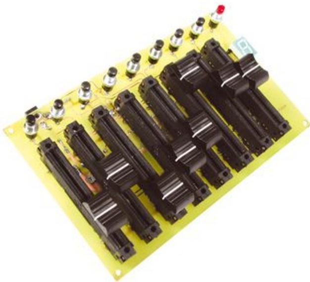
Controller standard DMX ad otto canali con slider in grado di regolare l
