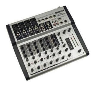
Mixer professionale a 8 canali con effetto riverbero ed eco digitale. Dispone di 4 ingressi MIC oppure LINE bilanciati / non bilanciati, 2 ingressi LINE stereo, ingresso/uscita record, uscita stereo, controllo toni a 3 bande su ogni canale, 2 VU-meter a 10 LED e alimentazione phantom 48 V.
