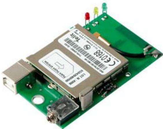
Modem particolarmente compatto utilizzabile in tutte le applicazioni nelle quali si ha la necessità di effettuare trasmissioni dati sfruttando la rete mobile GSM. È dotato di porta USB che ne permette l'interfacciamento a qualsiasi PC o Notebook provvisto di tale periferica. L'alimentazione al dispositivo è fornita direttamente dalla connessione USB. Il dispositivo viene fornito montato e collaudato.
