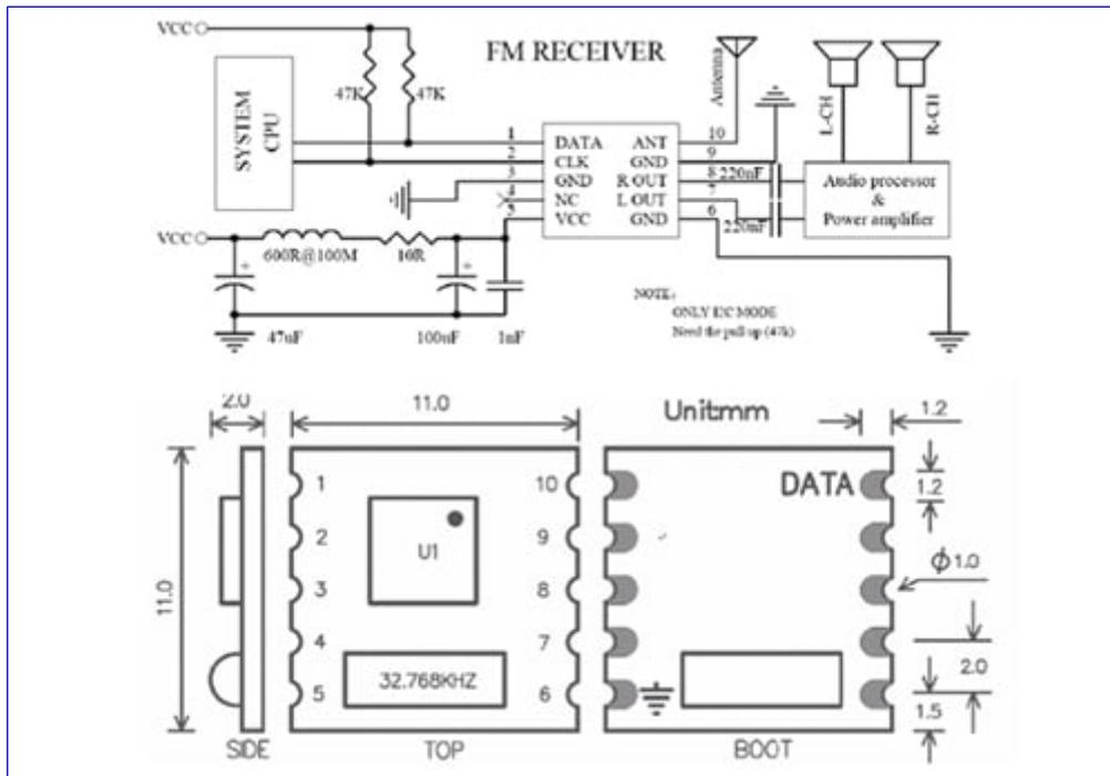
Basato sul chip della Philips TEA5767, questo piccolissimo modulo permette di realizzare, con l'aggiunta di pochissimi componenti esterni, una radio FM stereo con frequenza di ricezione da 87,6 MHz a 108 MHz.. Utilizzato in lettori MP3, MP4, cellulari, ecc.
