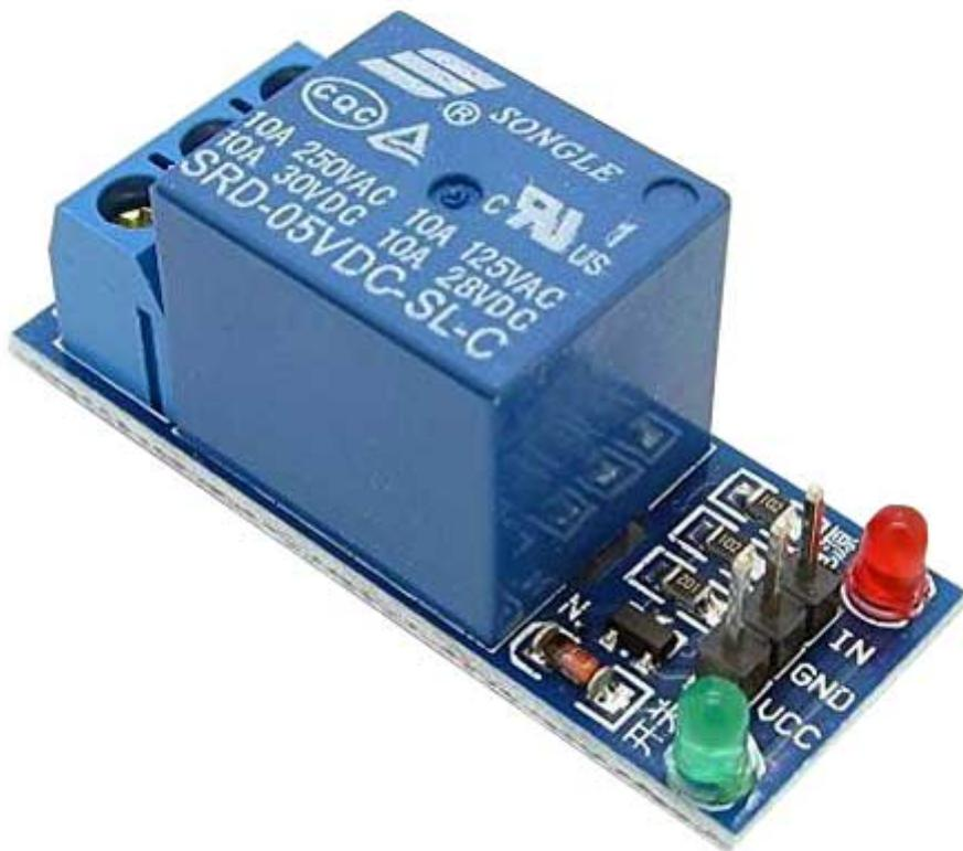
Modulo dotato di 1 relé, due LED di stato (alimentazione e relè), transistor e diodo. Consente di attivare/disattivare un carico max. di 10 A 250 VAC collegato allo scambio del relè. Il relè si attiva collegando il negativo al pin "IN". Particolarmente indicato per essere impiegato con Arduino, Fishino, sensore fotoelettrico (2846-IRFOTOSENS), ecc.
